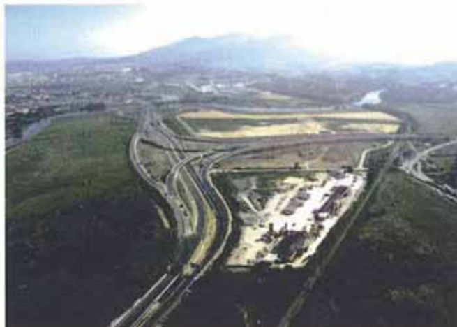
La ejecución del nuevo enlace resuelve todos los movimientos por medio de ramales directos, de tipo T-direccional, y evitará las detenciones e interferencias por medio de los tramos de bifurcación y confluencia.
