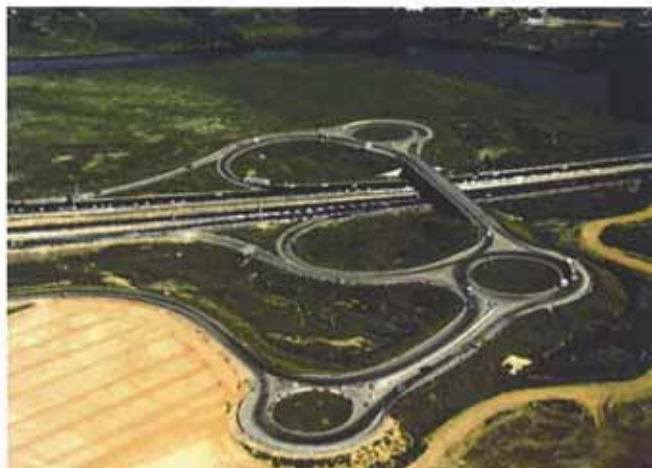
La ejecución del nuevo enlace resuelve todos los movimientos por medio de ramales directos, de tipo T-direccional, y evitará las detenciones e interferencias por medio de los tramos de bifurcación y confluencia.
