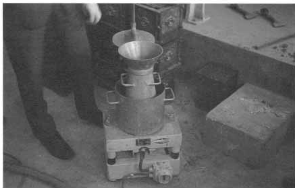
Dispositivos para confección de probetas de hormigón compactado: Martillo vibrante.
