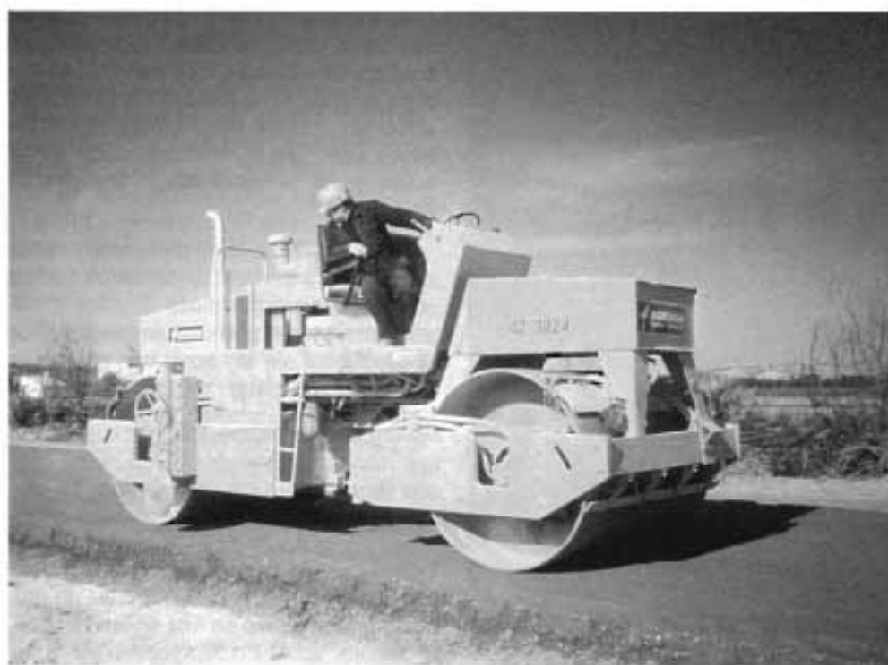
Compactación: rodillo liso vibrante.
