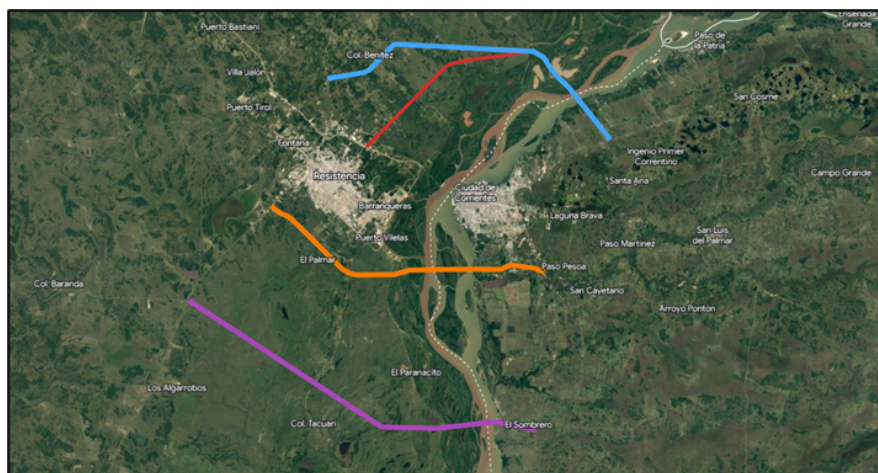
Figura 2. Alternativas de conexión entre Resistencia y Corrientes Fuente: Proyecto ejecutivo de la nueva conexión
