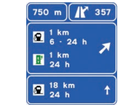
Figura 3. Ejemplo de diseño de preavisos en autopista o autovía con y sin subcartel inferior. Ambos muestran en el subcartel superior información sobre una estación de servicio y una estación de recarga eléctrica ubicadas en posiciones independientes dentro de la misma salida. En el cartel sin subcartel inferior, la inclusión de otros servicios disponibles en la salida obliga a suprimir dicho subcartel, conforme a los criterios establecidos en la OC 2/2024, por exceso tanto de información como de proporciones en el conjunto del cartel.
