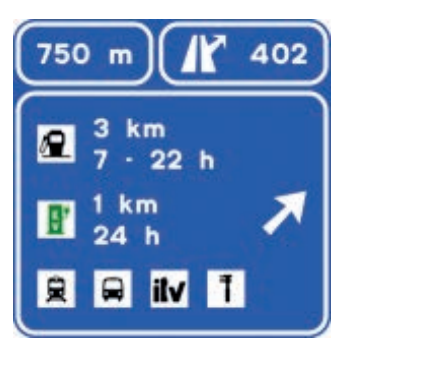
Figura 3. Ejemplo de diseño de preavisos en autopista o autovía con y sin subcartel inferior. Ambos muestran en el subcartel superior información sobre una estación de servicio y una estación de recarga eléctrica ubicadas en posiciones independientes dentro de la misma salida. En el cartel sin subcartel inferior, la inclusión de otros servicios disponibles en la salida obliga a suprimir dicho subcartel, conforme a los criterios establecidos en la OC 2/2024, por exceso tanto de información como de proporciones en el conjunto del cartel.
