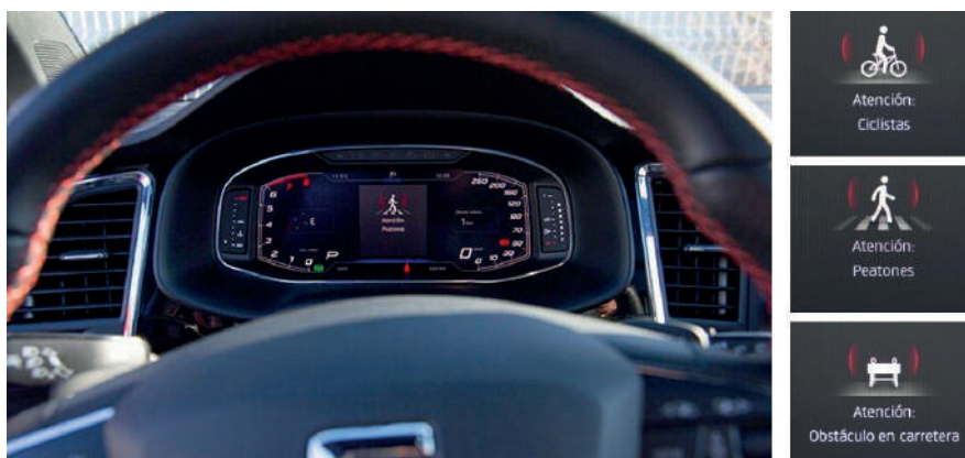
Figura 4. Detección de obstáculos en la carretera Fuente: Coches con G5: conducir con un sexto sentido (SEAT, https://www.seat-mediacycenter.es/ )
