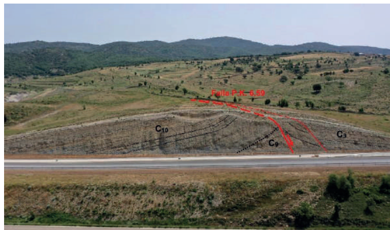
Figura 20. Panorámica de la Falla P.K. 6,59 con pliegue de arrastre y anticlinal debido a una posible reactivación tectónica durante el Cenozoico (Junio 2022)
