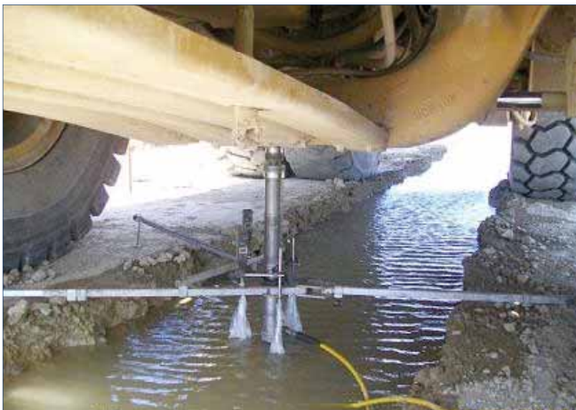
Figura 9. Detalle de la ejecución de las placas de carga inundadas
