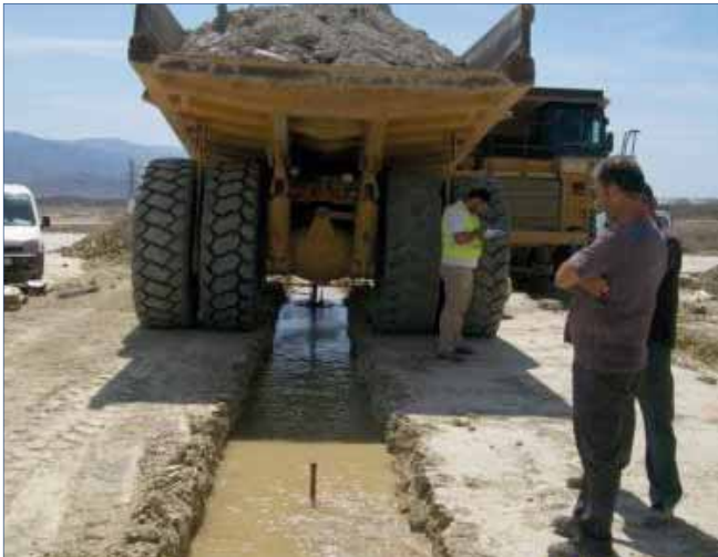
Figura 8. Fase de llenado de las zanjas. Saturación del terreno previa a la ejecución de las placas de carga inundadas
