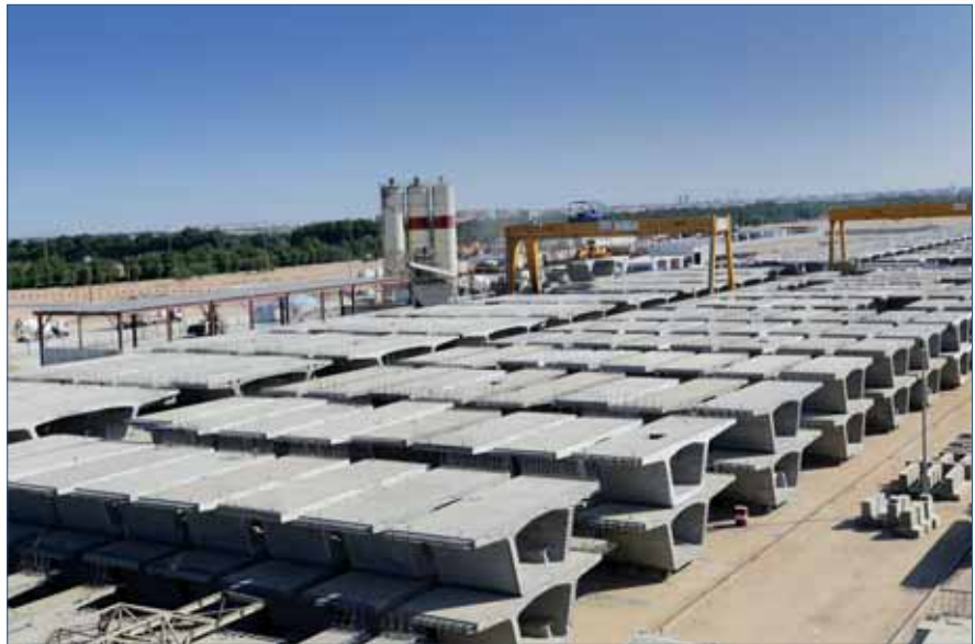
Figura 8. Parque de dovelas prefabricadas
