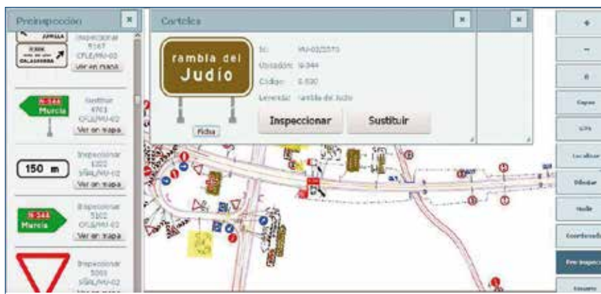
Figura 13. Aspecto de la pantalla de preinspección de señalización vertical sobre tableta de SIGex
