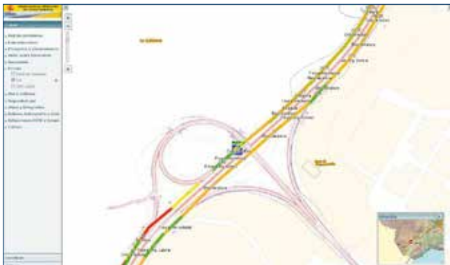
Figura 8. Representación del inventario de inspecciones visuales de firmes, incluyendo el indicador de estado, obtenido a partir de la naturaleza del deterioro, tráfico y prioridad
