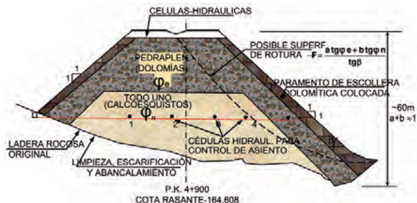
Figura 8. Encapsulamiento de todo-uno con pedraplén (Oña y otros, 1998)
