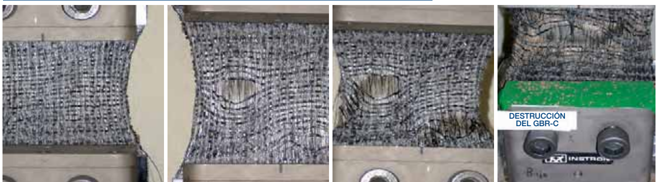
Figura 13. Diferentes aspectos de la rotura brusca del geotextil no tejido, y por tanto, simultáneamente la destrucción completa del geotextil tejido, ya que está agujado al geotextil no tejido. En ese momento es cuando se produce la salida al exterior de la bentonita, y por tanto, el GBR-C pierde su funcionalidad.
