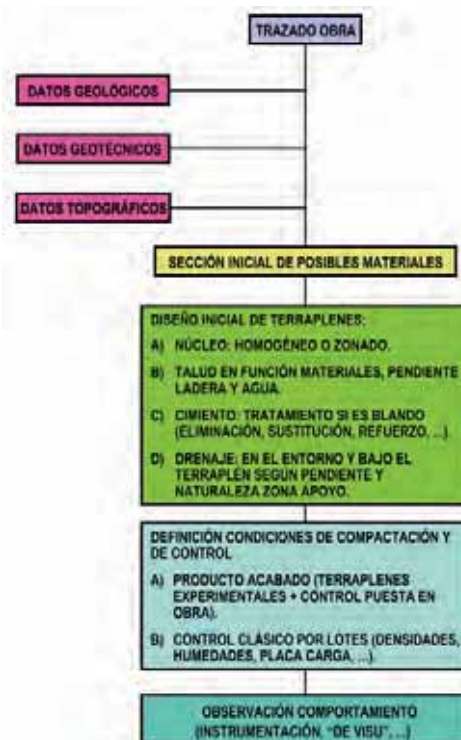
Figura 4. Diseño y ejecución de terraplenes
