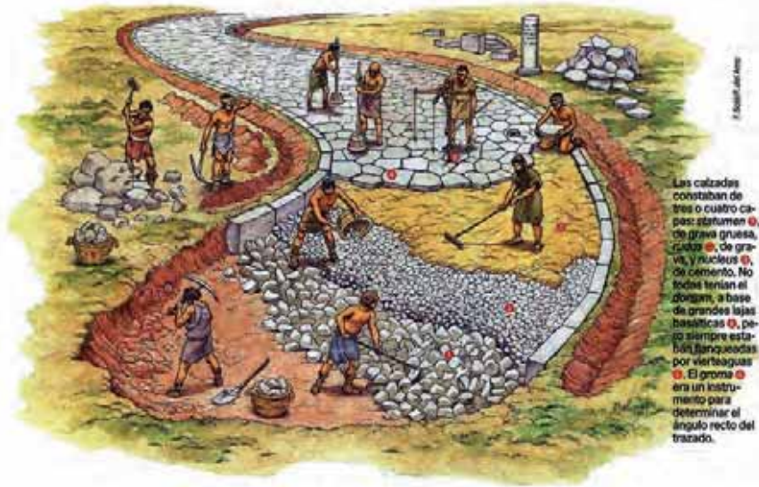
Figura 1. Drenaje en vías romanas (Fonseca, 1990)
