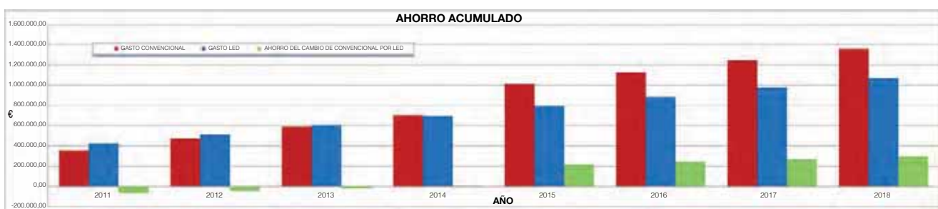
Figura 10. Comparativa entre coste con VSAP (HPS) y Leds para los túneles de Parpers
