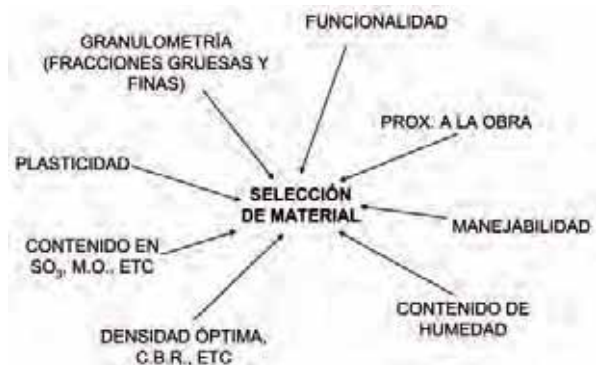
Figura 6. Selección del material de un terraplén (Oteo, 1994)
