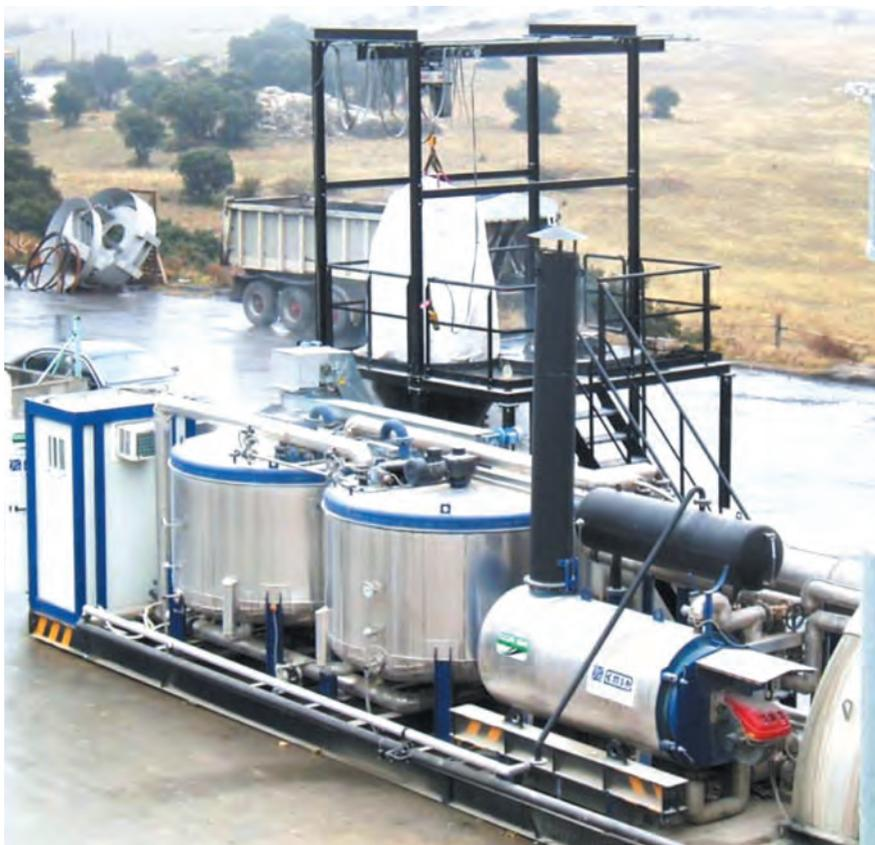
Foto 3. Instalación de fabricación de betún con polvo de neumáticos
