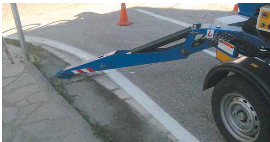
Figura 5. Apoyo de la plataforma elevadora.
