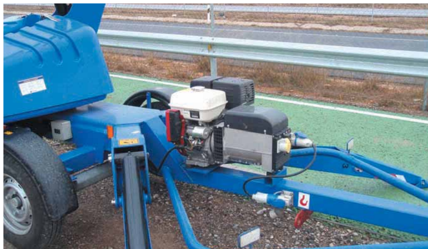
Figura 3. Generador eléctrico del Laboratorio Móvil de Tráfico.
