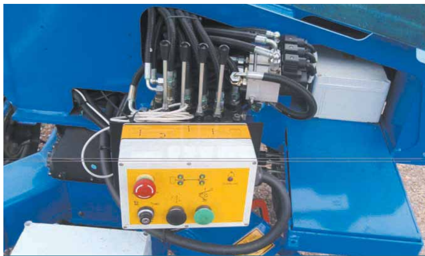
Figura 4. Cuadro de mandos del sistema hidráulico de elevación y estabilización.
