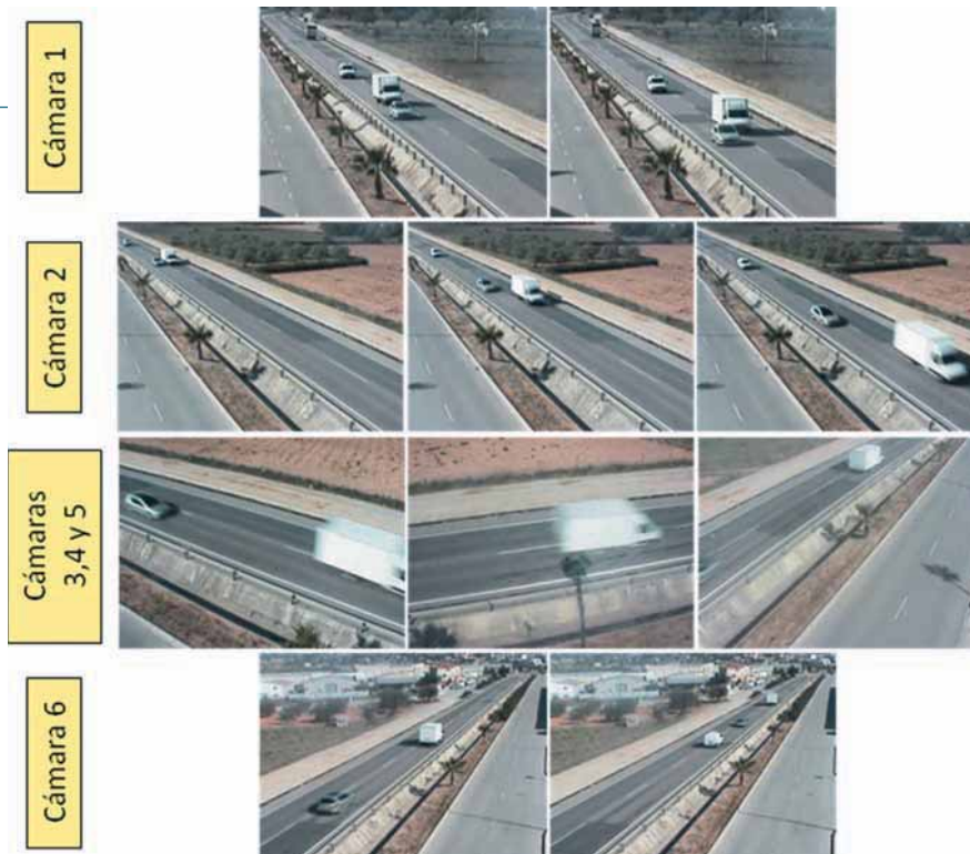
Figura 6. Maniobra de adelantamiento grabada con seis cámaras del Laboratorio Móvil de Tráfico.
